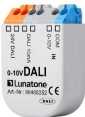
Der 0-10V to DALI Konverter wandelt ein 0-10V Analogsignal in einen DALI Dimmwert um. Das Modul stellt darüberhinaus eine DALI-Versorgung für einen kleinen DALI-Kreis mit bis zu 4 Lasten zur Verfügung. Potentiometer können direkt an den 0-10V Eingang des Konverters angeschlossen werden, auch PWM-Signale (>1kHz) können verarbeitet werden.
