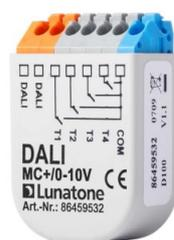
Das DALI MC+ ist eine Erweiterung des DALI MC. Die Eingänge können entweder als Schaltsignale oder auch 0-10V Analogsignale verarbeiten bzw. Potentiometer einlesen. Darüber hinaus werden DALI-Befehle zur Steuerung der Farbtemperatur unterstützt.
