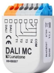
Das DALI MC ist ein Interface zum Anschluss von 4 Schaltern oder Tastern. Jedem Eingang können via PC-Software diverse DALI-Befehle zugeordnet werden: dim up, dim down, off, recall min., recall max., goto scene 1-16, direct ar-power ...%, mask und vordefinierte Macros. Das kompakte DALI MC kann in die Unterputzdose hinter dem Schalter eingelegt werden und macht so aus einem handelsüblichen Lichtschalter bzw. Taster einen DALI Bediengerät.
