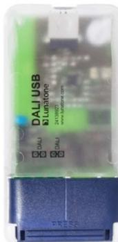
Das DALI USB ist ein PC-USB Schnittstellenmodul für DALI Systeme. Mit diesem Interface können von einem PC aus unter Verwendung der Installationssoftware DALI-Anlagen und Betriebsgeräte adressiert, programmiert und natürlich auch gesteuert werden.
