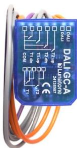
DALI GC und GC-A sind Steuergeräte zum Ansteuern von 2 DALI Gruppen. Lichtschalter oder Taster können mit Hilfe dieses kompakten Moduls Dimm- und Schaltbefehle an zwei DALI Gruppen senden. Ein Drehschalter am Gehäuse des DALI GC bietet die Möglichkeit die gewünschte DALI- bzw. Leuchtengruppe vorzuwählen. Die Module werden in die Unterputzdosen hinter den Lichtschaltern eingelegt und direkt über den DALI-Bus versorgt.
