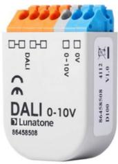
Das DALI 0-10V PWM Interface wandelt DALI-Signale in ein pulswidenmoduliertes Ausgangssignal um und ermöglicht das Einbinden von EVGs oder LED-Vorschaltgeräten mit 0-10V Ansteuerung und entsprechendem Eingangsfilter in DALI-Systeme.
