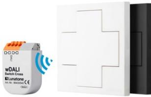
Der wDALI Switch ist ein DALI-Steuermodul, welches kabellos an den DALI-Bus angebunden ist. Der batteriebetriebene Schalter kann ohne Installationsaufwand an jedem beliebigen Ort montiert werden. Jeder Taste des wDALI Switch können Zieladresse, Schaltverhalten und DALI-Kommandos zugewiesen werden. Die folgenden DALI-Befehle stehen dafür zur Verfügung: dim up, dim down, off, recall min., recall max., goto scene 1-16, direct arcpower ...%, mask und vordefinierte Macros.
