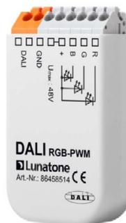
Das DALI RGBW-PWM Interface ermöglicht die direkte Ansteuerung von Leuchten mit RGB- oder RGBW-Eingang. Eingangsspannung 6V bis 48V, 4 PWM-Ausgänge (16 Bit), 1 DALI Adresse
