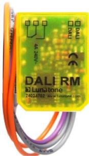
Das DALI RM stellt einen über den DALI-Bus steuerbaren Relaiskontakt zur Verfügung, welcher zum Schalten von Leuchtkörpern und Kleinverbrauchern oder zum Ansteuern von Schützen verwendet werden kann. Lasten ohne DALI-Eingang können auf diese Weise in das DALI-System eingebunden werden.
