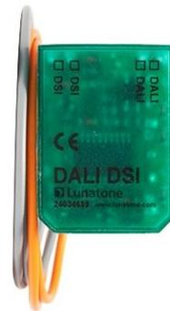
Umsetzer von DALI Bus auf DSI-Signale zur Integration DSI-basierter Betriebsgeräte in DALI Lichtsteuersysteme. Dieses kompakte Modul findet in konventionellen Unterputzdosen Platz und integriert DSI basierende Vorschaltgeräte wie PCA ECO für Leuchtstoffröhren, TEL Transformatoren für Halogenlampen oder Phasendimmer PHD in ein DALI-Lichtsteuersystem. Das DALI-DSI erhält vom DALI-Bus eine eigene Adresse und kann sowohl Gruppen als auch Szenen zugeordnet werden.
